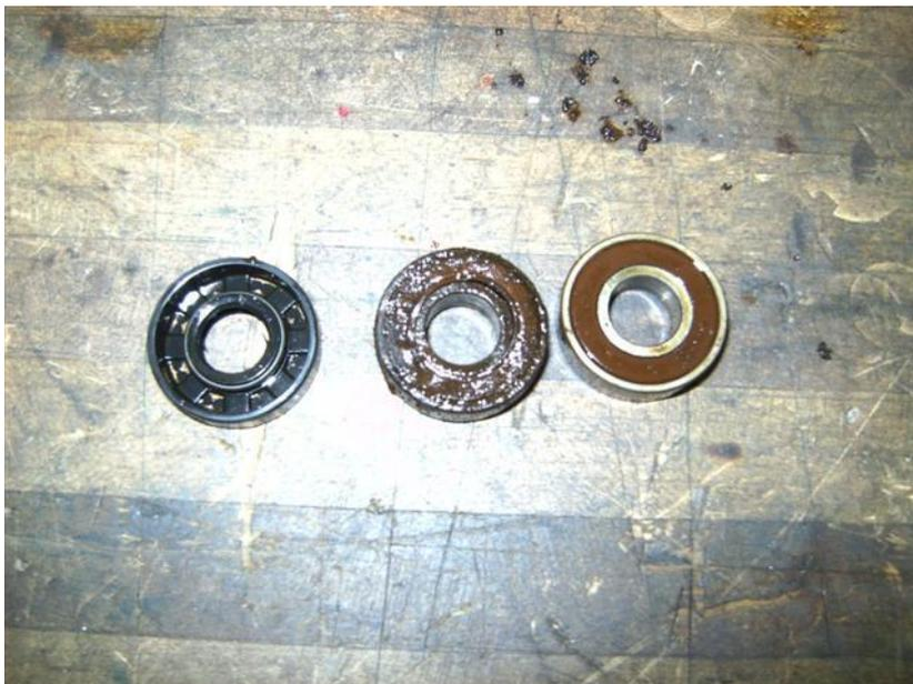
So sieht die Dichtung auf der Kühlmittelseite aus, die wir wiederverwenden werden. Sieht aus wie eine Keramikdichtung. (mittleres Bild)
