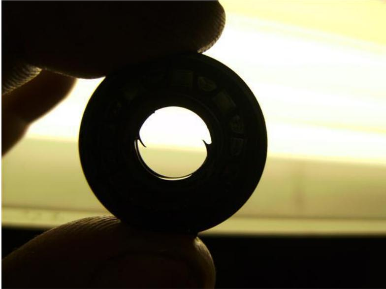
Pumpinnenlager, ölseitig *mit entferntem Sprengring*
